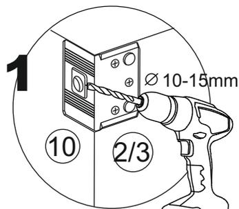
Просверлите заднюю стенку сверлом  $\phi 10-15$  мм в центре прямоугольного отверстия на навесе.
